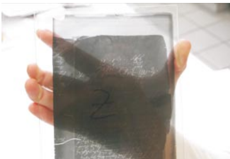
Obr. 10 Citlivá vrstva na nové podložce bez vzduchových bublin
