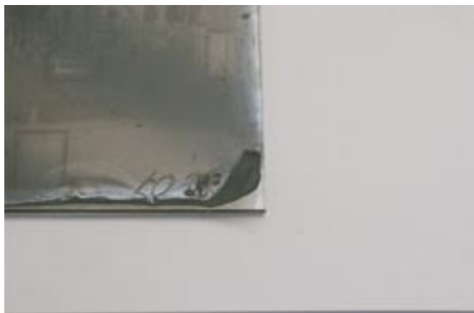
Obr. 16 Citlivá vrstva s nedostatečnou adhezí ke skleněné podložce
