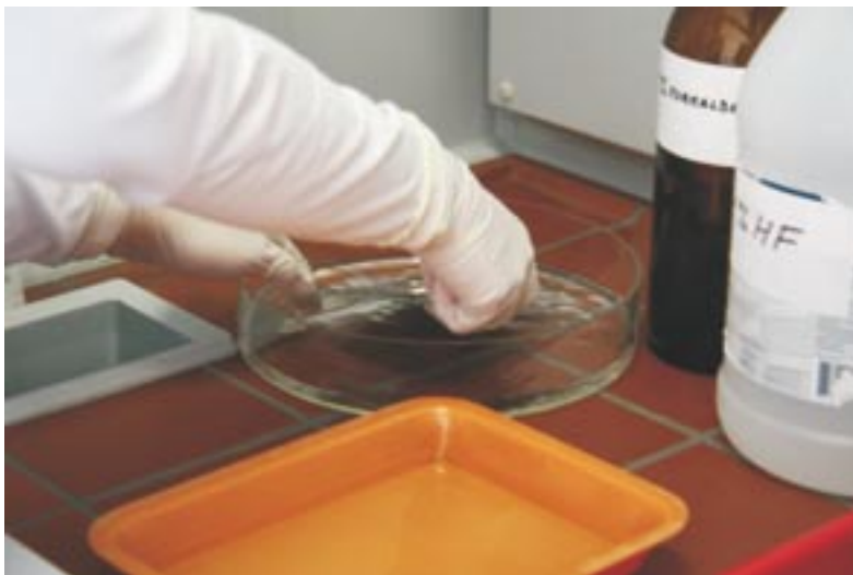
Obr. 1 Vložení negativu do lázně 2% roztoku formaldehydu
